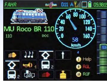
◀ Fahrpult im Funkbetrieb (mit Antennensymbol oben)
