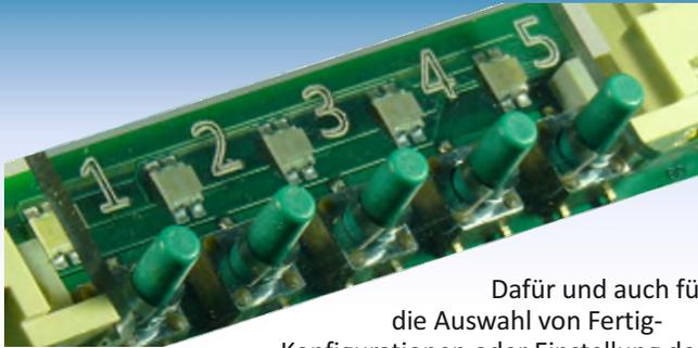
Dafür und auch für die Auswahl von Fertig-Konfigurationen oder Einstellung der Modulnummer dienen die **5 Tasten am StEin**.
